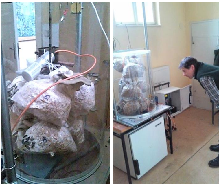
Obr. 4. – svojpomocne zhotovené automaty, skladajúce sa so snímača Vaisala CARBO CAP a transparentnej komory o rozmeroch Ø35cm *75 cm (4a komora), Ø35cm *100 cm (4b komora)
